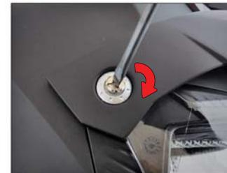
Per installare: posizionare il frontino, le guarnizioni ad anello ed avvitare in senso orario le tre viti del frontino, una superiore e le due laterali.
